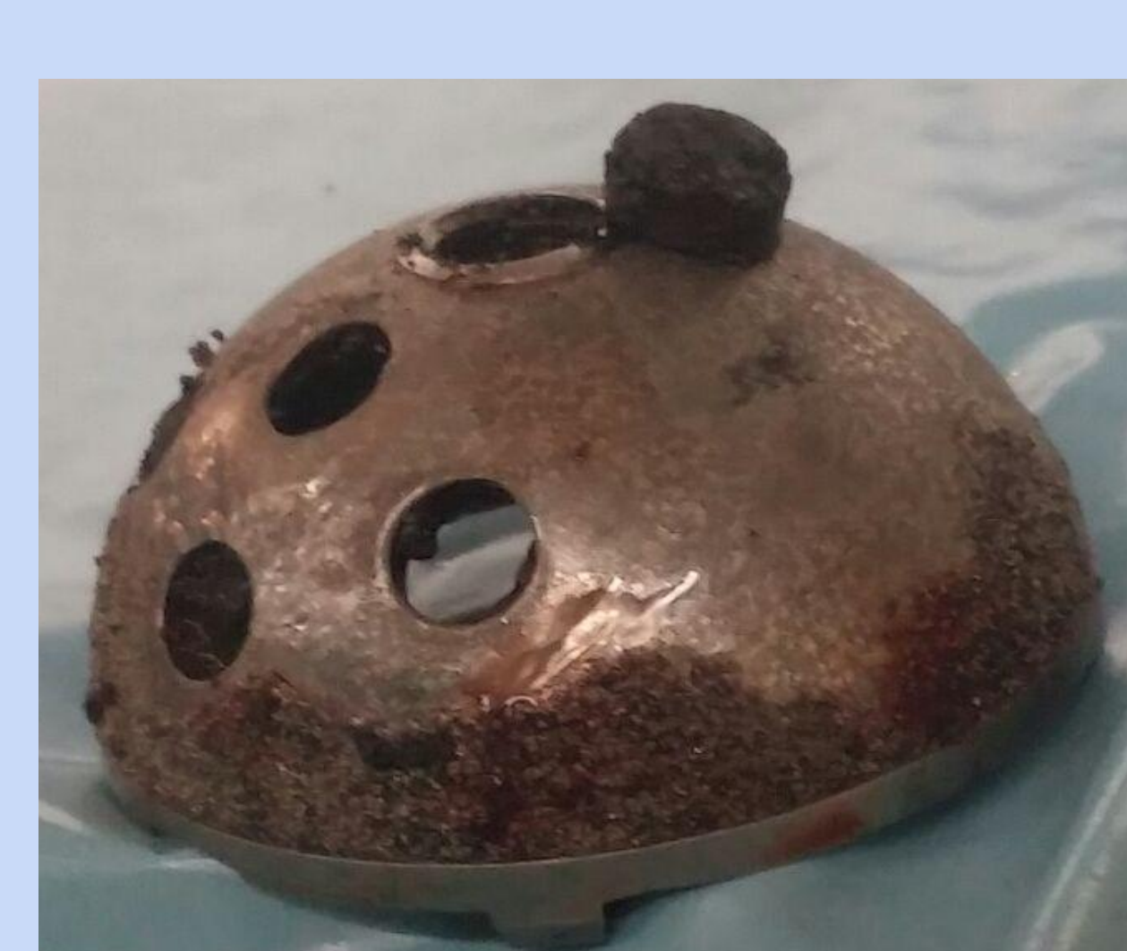
Fig. 2. Izq: Pseudotumor y metalosis en zona capsular. Centro: recubrimiento de titanio desprendido e impactado en cavidad acetabular. Der: cotilo extraído, con pérdida prácticamente total del recubrimiento.
